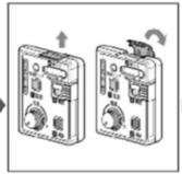
3 音声メモリーを袋から取り出す。 ICプレーヤー表面が見えるよう にした状態で、矢印の面を表にして、奥に突き当たるまでしっかり と差し込む。
