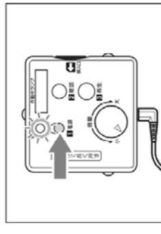
⑧ イヤホンの左右を確認してから、耳に付けて、②の「確認ボタン」を、「作動中ランプ」が光るまで、長く押し続ける。
