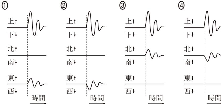
P波の初動前後の地震計の記録。上下方向，南北方向，東西方向の記録をそれぞれ示している。破線はP波の到達時刻を表す。
